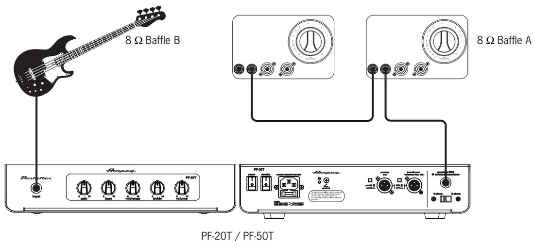
Remarque : Utilisez des baffles de même impédance pour la connexion en cascade.
